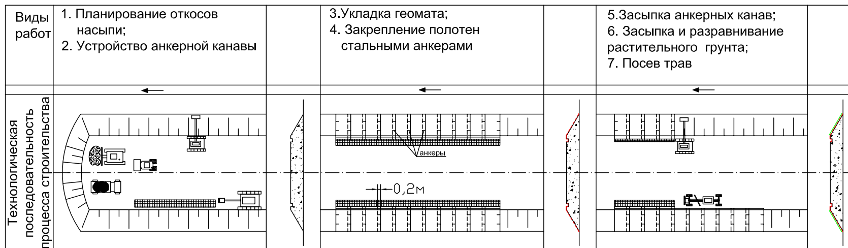
Технологическая схема укрепления откосов геоматами
