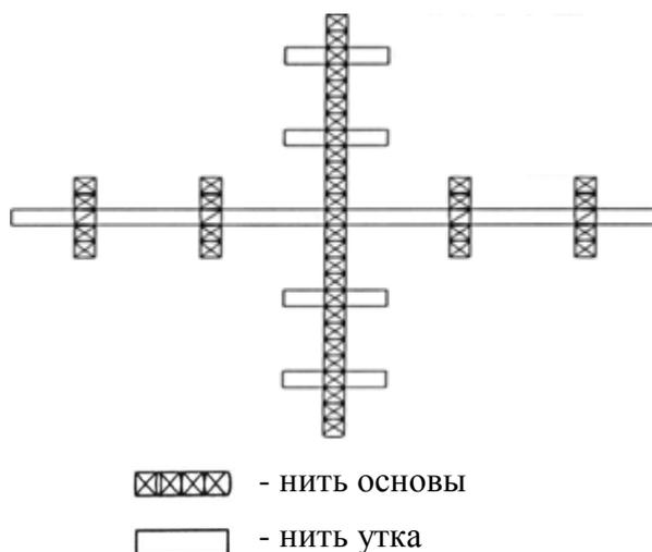
Рисунок 1 – Проба для определения прочности узловых соединений
